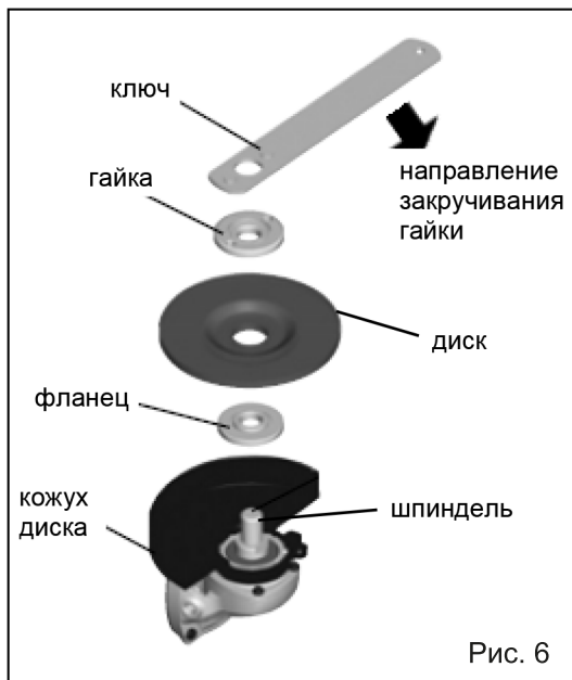
1 – ключ 2 – кнопка фиксатора шпинделя
